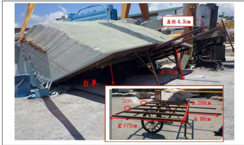
圖 1、因搬運輔具設計不良間接造成的傷害[4]。
